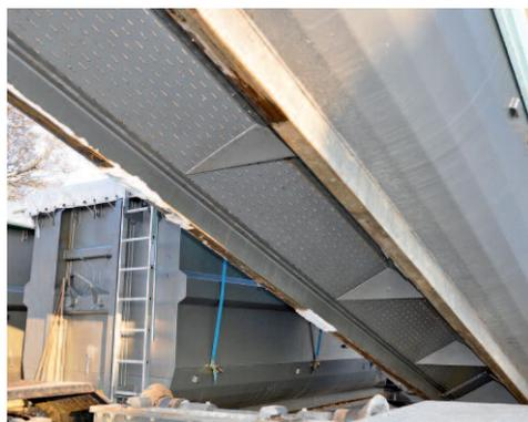
Links: Am Boden des Containers lassen dachförmig angeordnete Schlitzbleche die Trocknungsluft einströmen.
