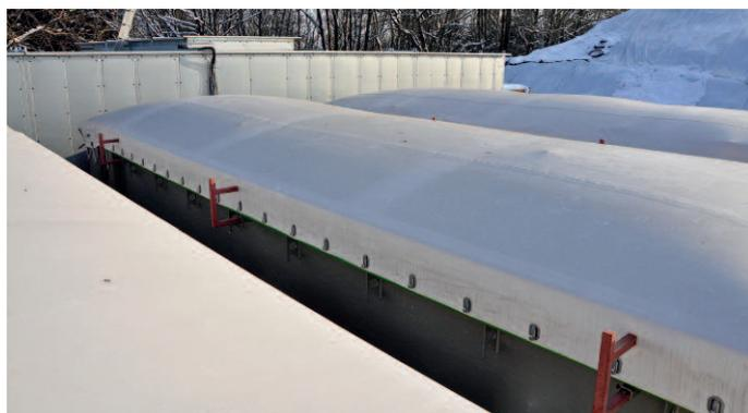
**Unter den Abdeckfolien auf den Trocknungscannern staut sich die Luft, die anschließend aktiv abgesaugt wird, um mit deren Wärme frische Zuluft anzuwärmen.**
